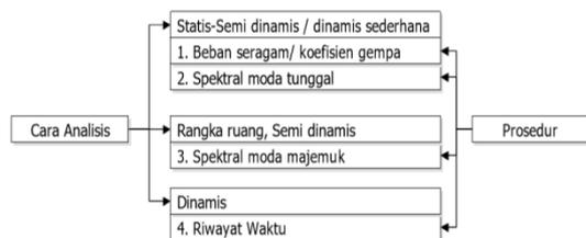
Gambar 6 Prosedur Analisis Gempa Untuk Jembatan (Sumber: SNI 2833-2008)
